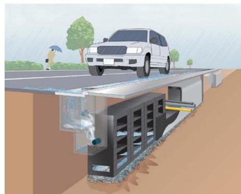
雨水貯留・浸透施設のイメージ
