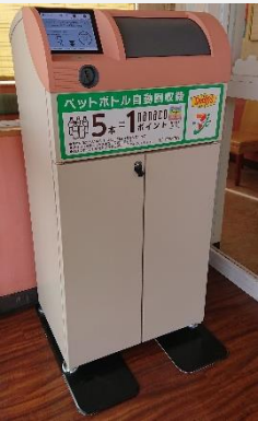
ペットボトル自動回収機
