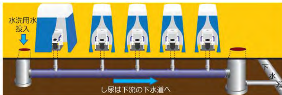
図 3-17 マンホールトイレの構造イメージ
