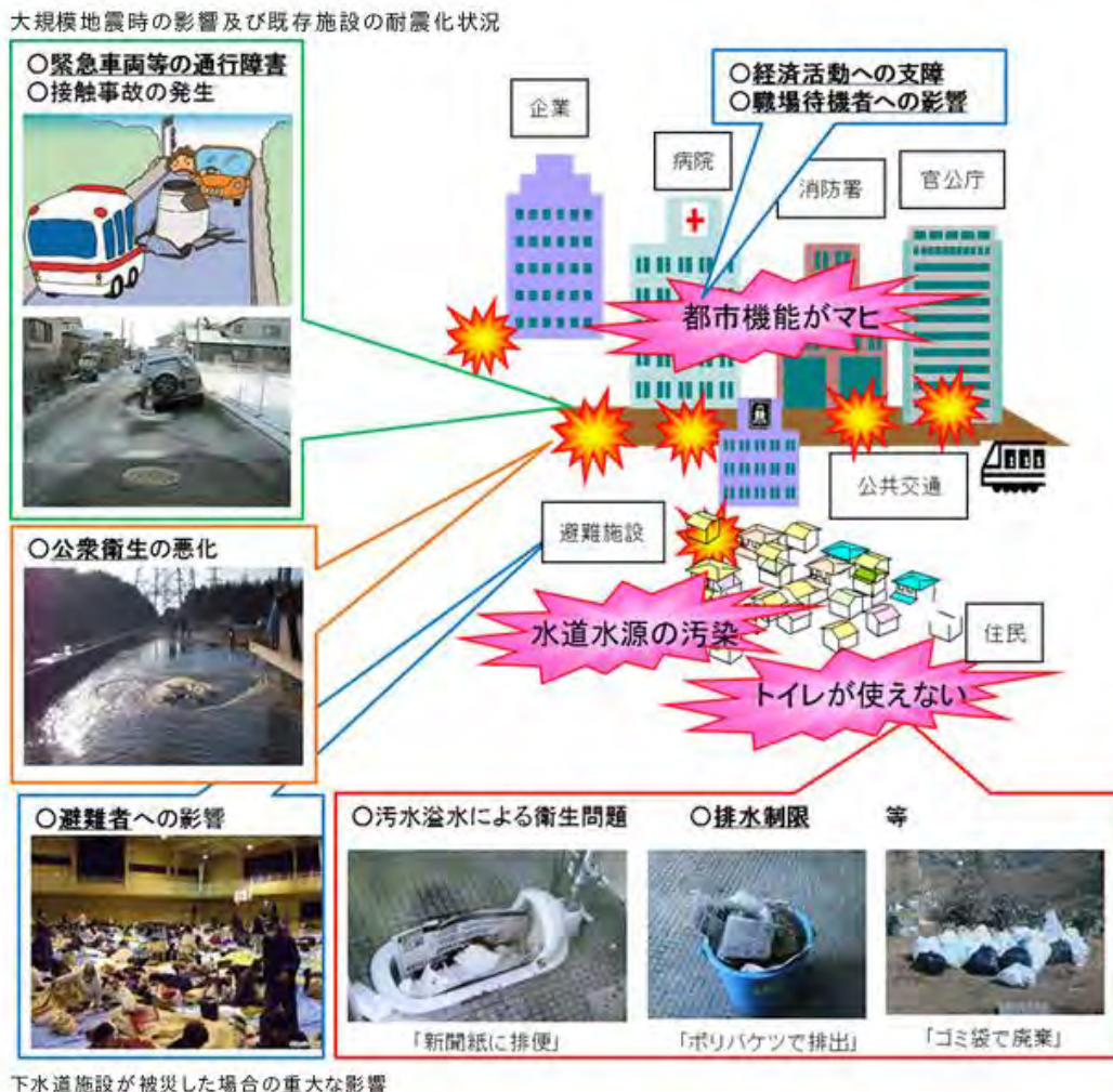
下水道施設が被災した場合の重大な影響
