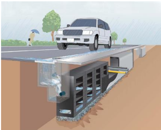
図5-2 雨水貯留・浸透施設（プラスチック製）のイメージ
