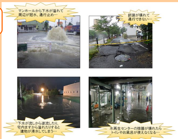
出展:「東京都下水道局ホームページ」 写真:雨天時浸入水の影響例
