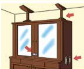
転倒防止器具で棚を固定、飛び出し防止器具の設置
